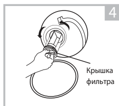
Откройте крышку фильтра, повернув против часовой стрелки
