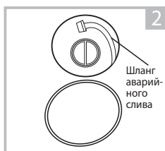
Поверните на 90 градусов выньте шланг аварийного слива, вытащите заглушку
