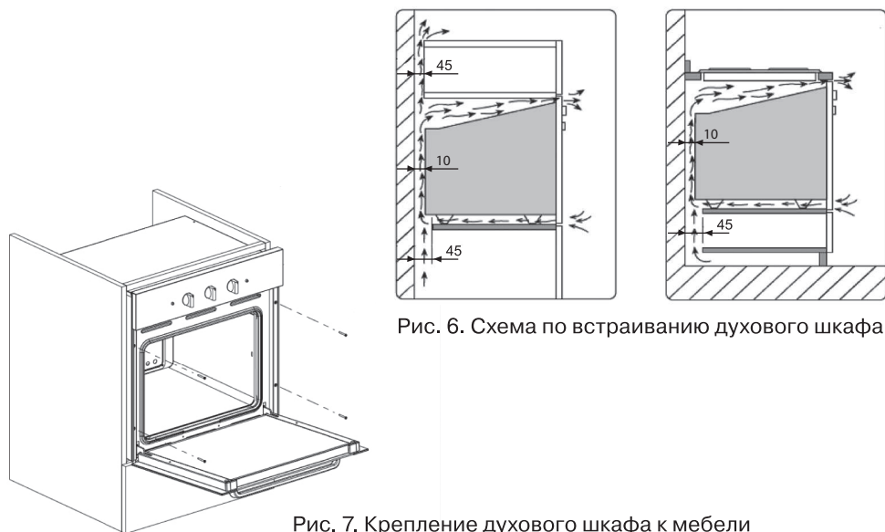
Рис. 7. Крепление духового шкафа к мебели
